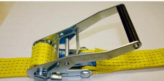
5. Durch Betätigung des Ratschenhebels mit einer Handkraft von ca. 50 daN der Gurt festzurren, um die erforderliche Vorspannkraft zu erreichen.
