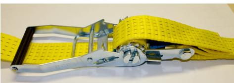
7. Um die Zurrung zu lösen, muss die Ratsche vollständig aufgeklappt werden. In dieser Position ist die Wickelwelle frei gegeben und das Gurtband kann einfach herausgezogen werden.
